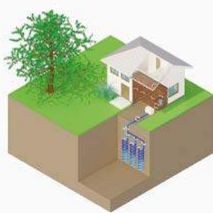
Pompe à chaleur sur corbeilles géothermiques
