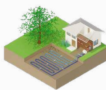
Pompe à chaleur sur capteurs enterrés horizontaux
